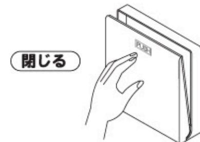
シャッターが開の状態でシャッターを押すと閉します。
